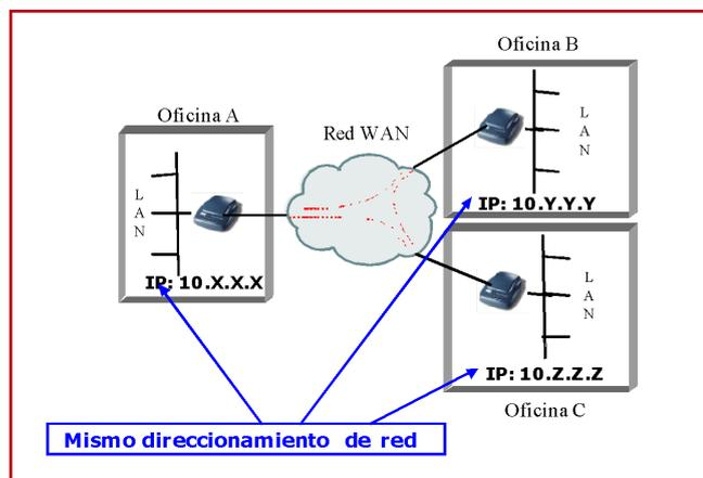
La conectividad necesaria en cada sitio se brinda mediante un equipo CPE (Customer Premises Equipment) que cuenta con 1 (uno) interface RJ-45 hembra y un cable de red UTP Fast Ethernet de 1 (uno) metro de longitud, como punto de acceso a la red LAN del Cliente y delimitación del Servicio.
